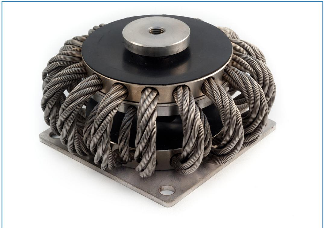
La serie AVAUD è l'evoluzione della linea AVAU: l'aggiunta di un secondo avvolgimento assegnato esclusivamente a smorzare le vibrazioni rende il supporto in grado di isolare separatamente le vibrazioni e gli urti.
